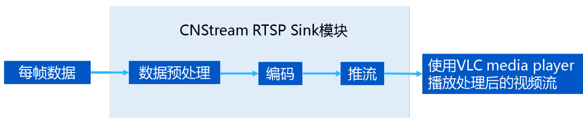
图 4.1: RTSP Sink 模块数据处理流程
